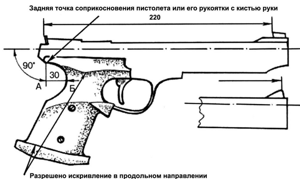
Рис. 3.2. Размеры стандартного малокалиберного пистолета и пистолета (револьвера) центрального боя.
