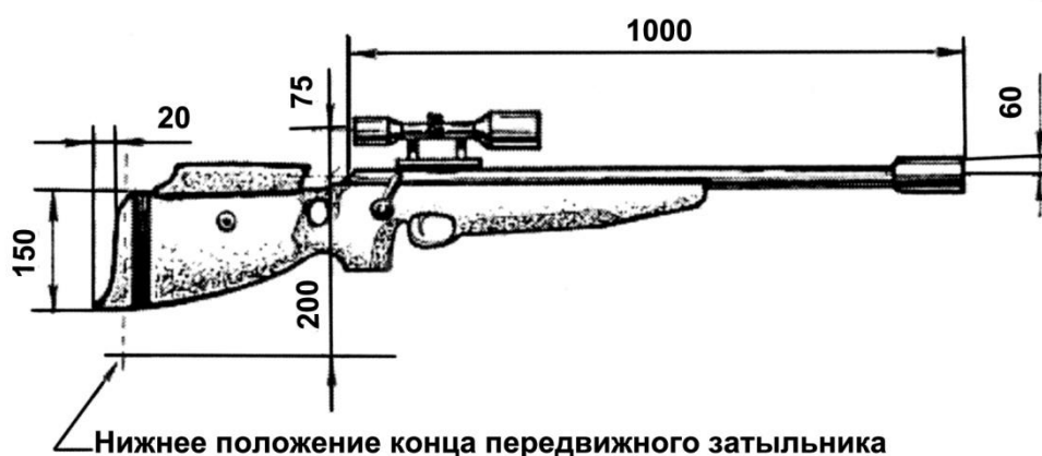
Рис. 4.1. Винтовка для стрельбы по движущимся мишеням
