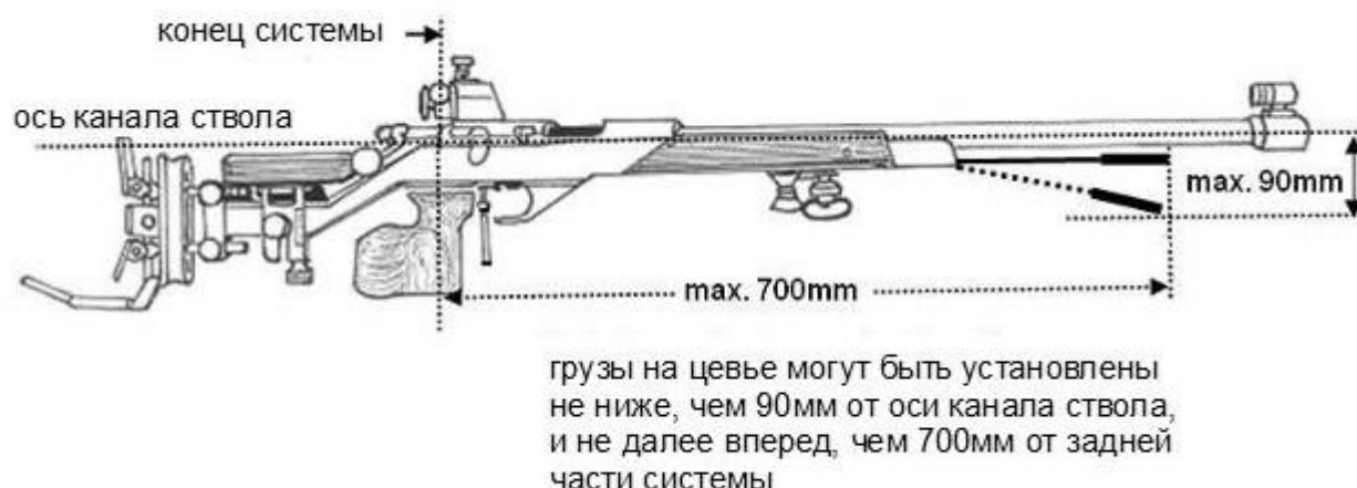
Рис. 2.3. Расположение грузов на цевье винтовки
